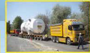
300 ton Siemens Gaz Türbini Nakliyesi
