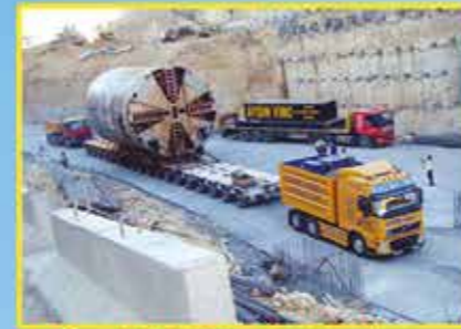
Istanbul'da 450 ton TBM nakliyesi
